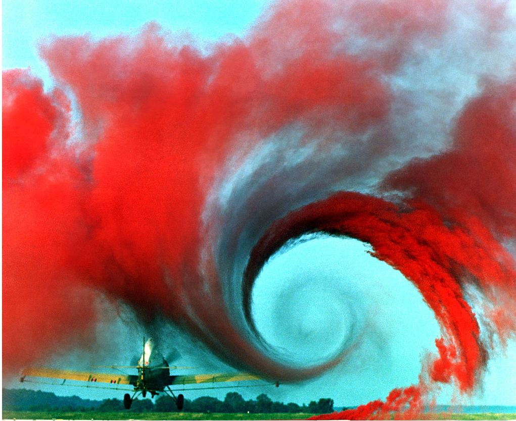
Hình 7: Sự nhiễu loạn sau cánh máy bay có thể quan sát thấy khi sử dụng khói màu.
